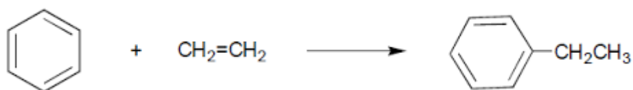
Figura 2: reacción de alquilación de benceno con etileno.
