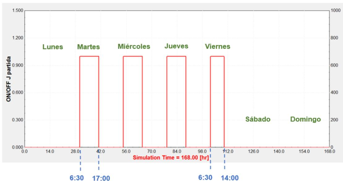
Gráfica 6. Señal de ON/OFF para los equipos de la instalación de calefacción
