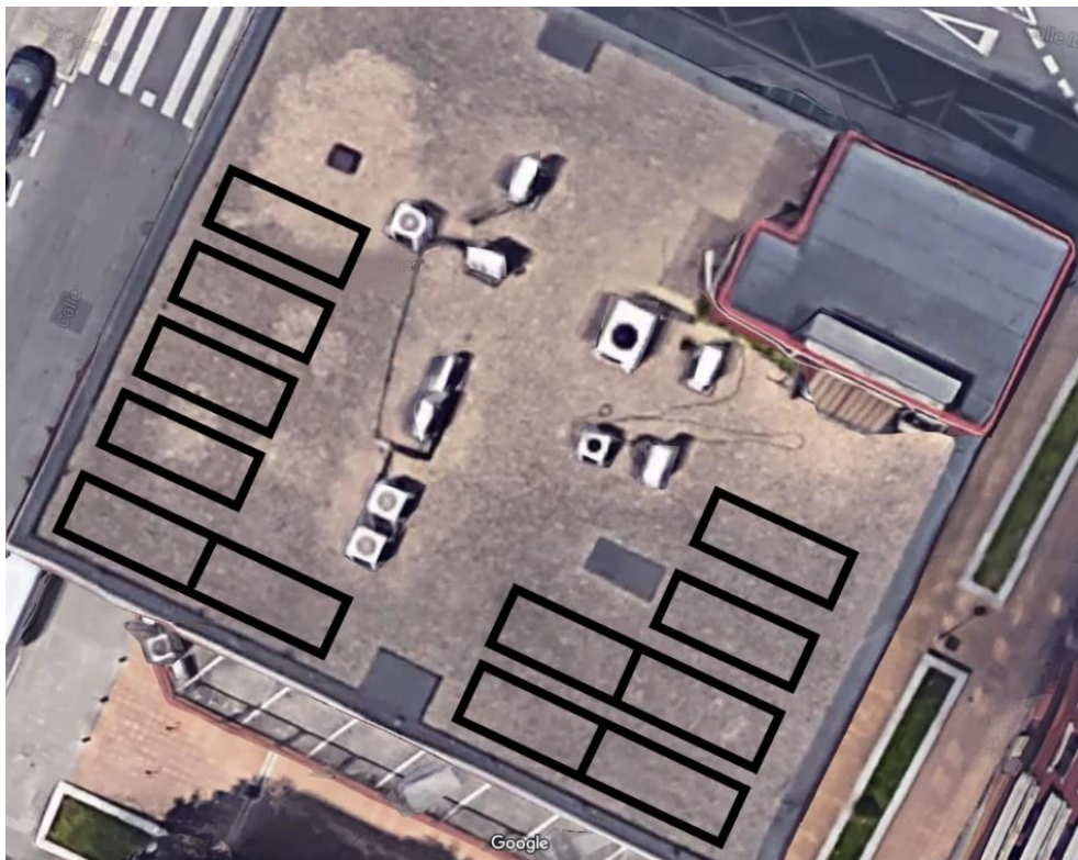
Ilustración 4: Disposición de paneles fotovoltaicos en la azotea del edificio
