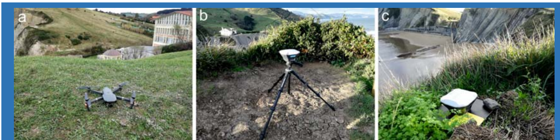
Figura 9. a) Dron utilizado en el trabajo de campo; b) Estación fija de GPS; c) Estación móvil de GPS.
