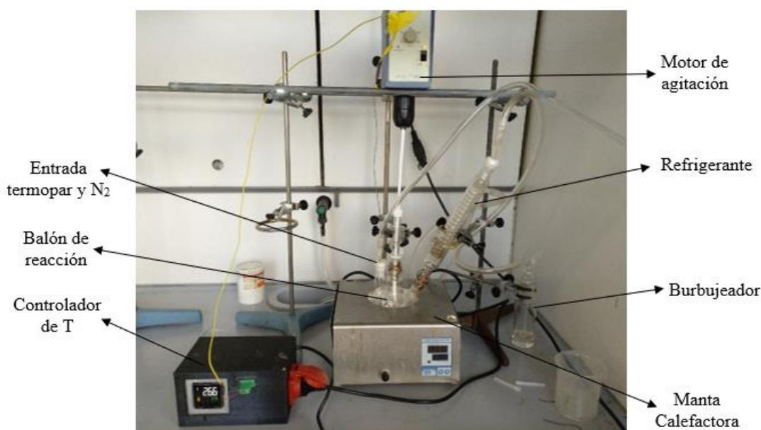
**Figura 10.** Montaje experimental para la síntesis de oleatos.
