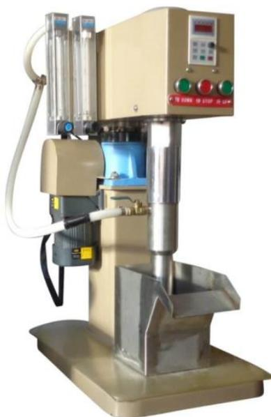
**Figura 13.** Equipo de flotación mecánica de laboratorio 911 MPE-D12-A. (911 Metallurgist, 2017).
