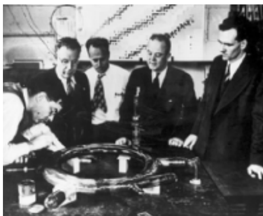
6. irudia. General Electric-eko taldea (ezkerretik esku-mara, Langmuir, Elder Gurewitsch, Carlton eta Pollock), 70MeV-ko sinkrotroiaren huts-hodia begiratzen ([2] aipamen bibliografikotik hartua).
