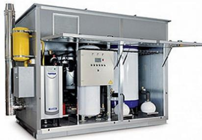
La caldera rooftop consiste en una solución prefabricada de una sala de calderas; es un equipo autónomo de generación de calor, personalizable según las necesidades de nuestro edificio y que está compuesto a base de calderas de gas. Estos equipos están pensados para su instalación en espacios exteriores, poseen una estructura autoportante y están pensados para que su mantenimiento se pueda llevar a cabo desde el exterior. Quedan diseñados en conformidad con el RITE y UNE 60.601
