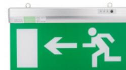
El alumbrado de evacuación proporciona, según la ITCBT-28, una iluminancia horizontal de 1 lux durante una hora como mínimo. En los cuadros de distribución del alumbrado, la iluminancia mínima será de 5 lux. El alumbrado ambiente o antipánico debe proporcionar una iluminancia horizontal de 0,5 lux durante un mínimo de una hora para poder realizar la evacuación de forma ordenada.
