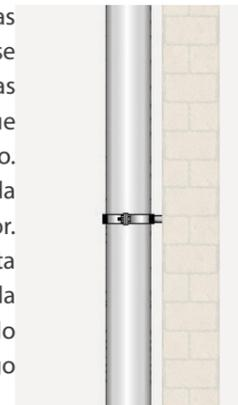
A estas aguas recogidas de las cubiertas, se le añade el agua proveniente de los sumideros de las **plazas**. La recogida de las plazas se realiza a través de unas rejillas ocultas en el pavimento y bajo la doble piel, donde recogen el agua y se conectan a las bajantes de cubierta hasta llevar el agua al depósito.
