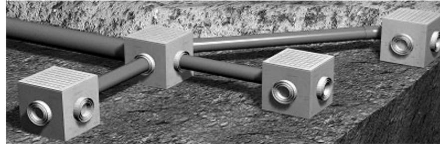
Por último, al final de la instalación y antes de la acometida se dispone el **pozo de registro** correspondiente a el edificio, donde se recogen todas las aguas residuales.
