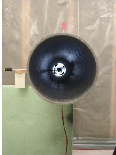
Figura 4-8: Anemómetro dentro de un conducto de ventilación con ventilador conectado a un potenciómetro para regular el caudal de ventilación
