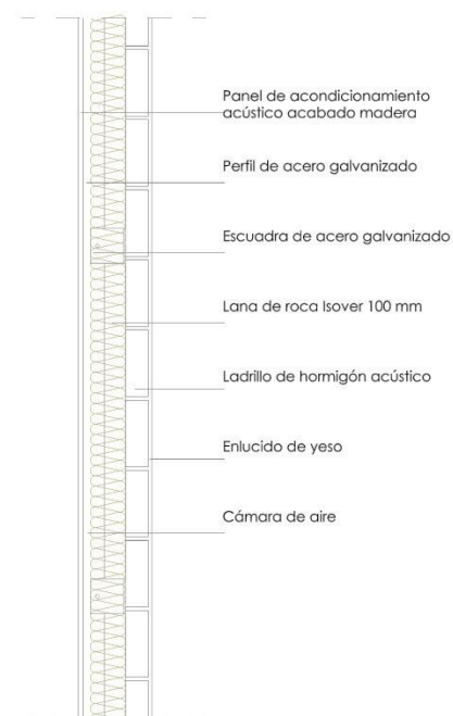
T4 Tabique aislamiento acústico
