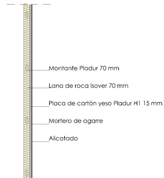
T8 Trasdoso a muro en zona húmeda
