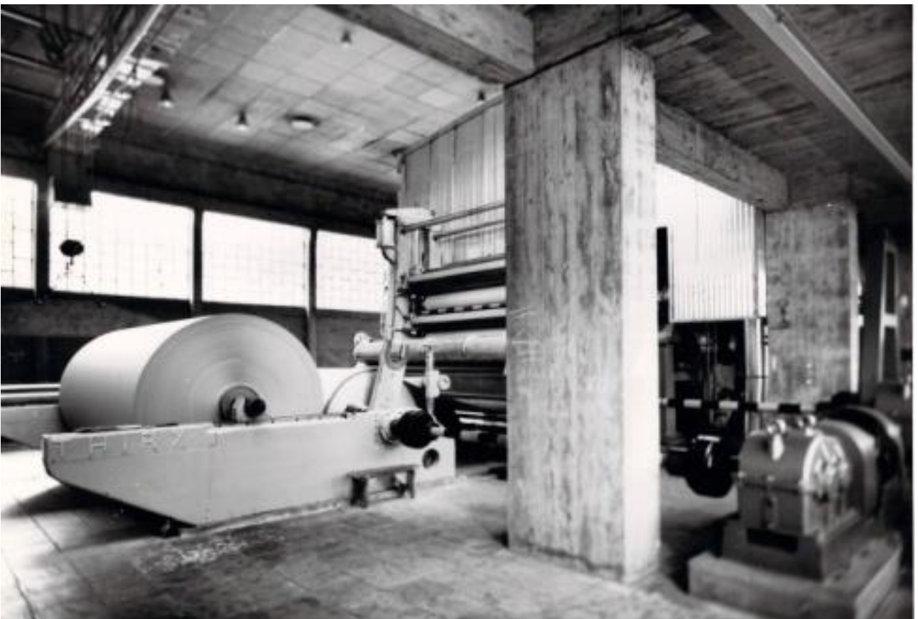
Fig. 3.177: Instalación de rebobinamiento del papel de la máquina instalada al interior del pabellón de cubierta abovedada. (AEPE F 710)
