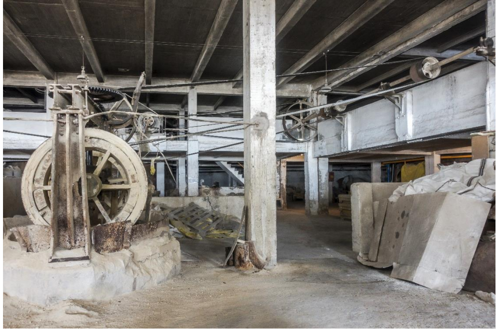
Fig. 3.355: Molinos de rulos y el sistema de accionamiento mediante correas. (Ana Vitoria)
