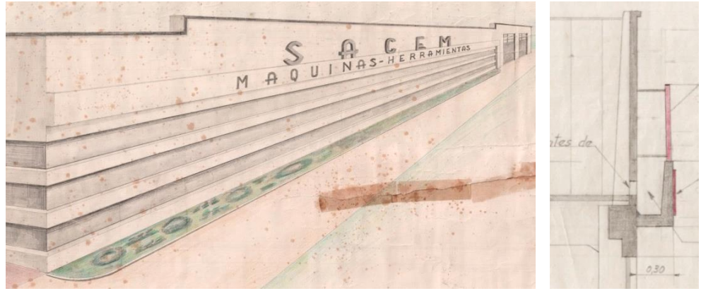
Fig. 3.240: Proyecto de canal desagüe de lluvias y rótulo de fachada. (AMV 1956-1964)
