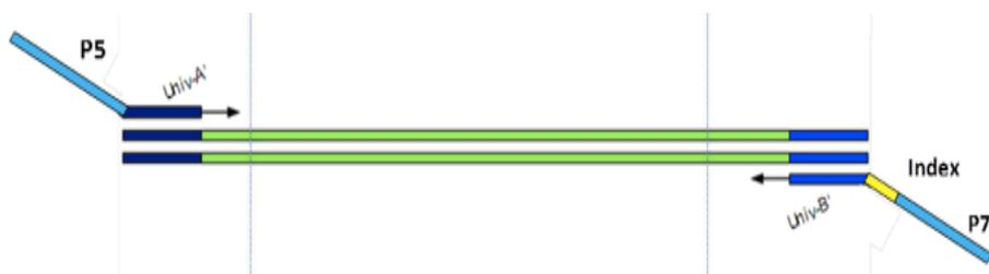
Figura 32. Dibujo esquemático de la unión los adaptadores P5 y P7 y el index al producto purificado obtenido de la PCR I.
