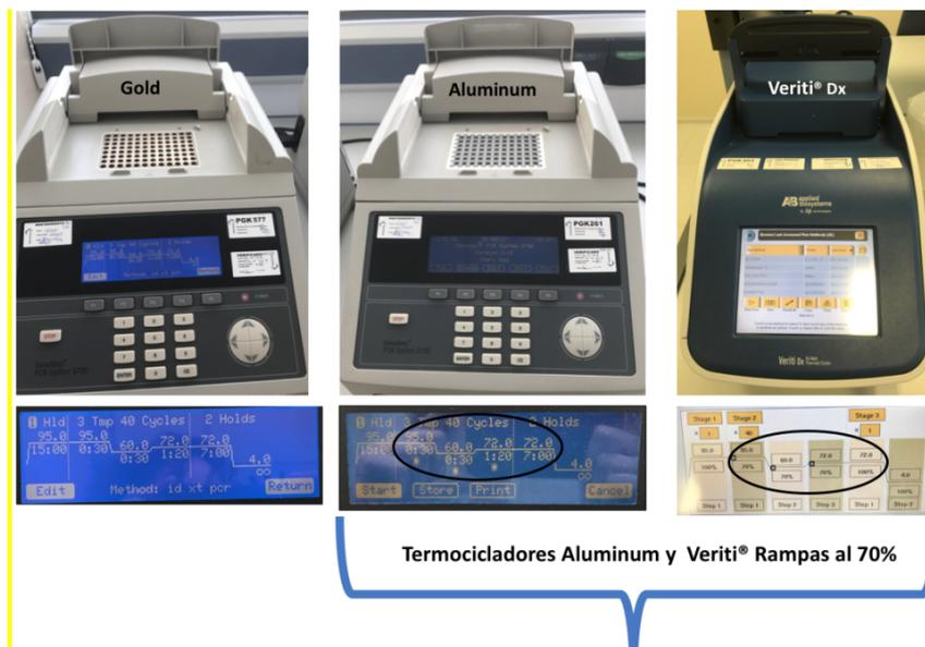
**Figura 13.** Termociclador Gold, Aluminum y Veriti® 96-Well o Veriti® Dx 96-Well, donde se observan las rampas al 70% en el termociclador Aluminum y Veriti.
