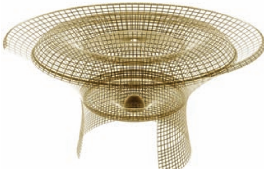
FIG. 6 Modelo mallado de las dos superficies hiperbólicas y las tres bóvedas tóricas.
