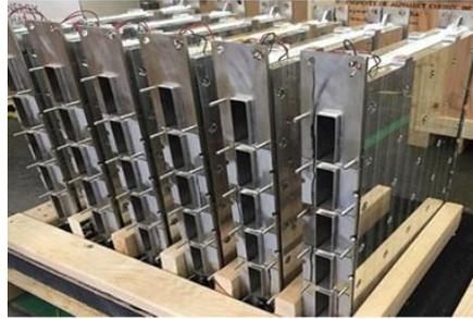
Fig. 20. Alphabet Energy PowerModule- $\gamma$ <sup>TM</sup>
