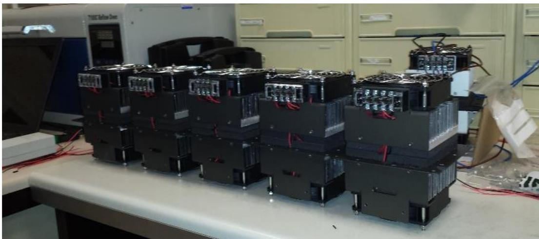
Fig. 28. Sistemas termoeléctricos con intercambiadores Aire-Aire desarrollados por Centro Stirling [72]
