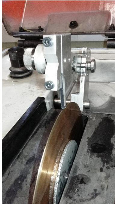
Fig. 295. Corte de muestras rectangulares
