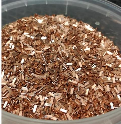
Fig. 365. Pletinas de cobre empleadas en la fabricación de los terminales del módulo.
