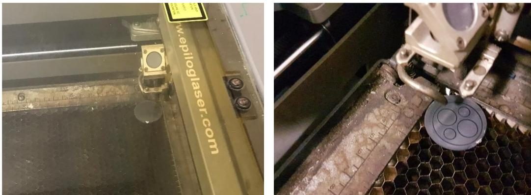
Fig. 334. Muestra de material termoelectrico marcada por el haz LASER.
