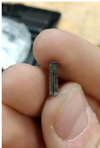
Fig. 332. Estructura en □ mecanizada con metalización del proceso de fabricación, aún sin pulir.
