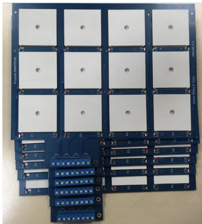
Fig. 77. Montaje de las PCBs con los módulos termoeléctricos
