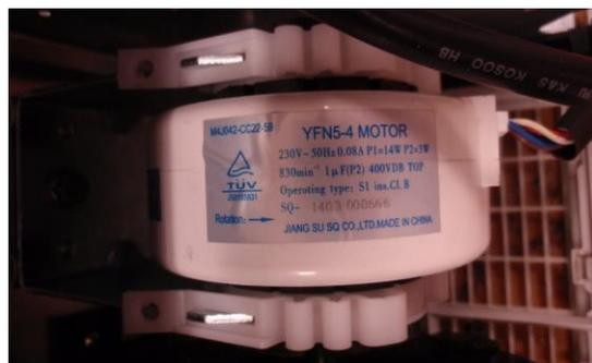
Fig. 179. Motor eléctrico original y sus características.
