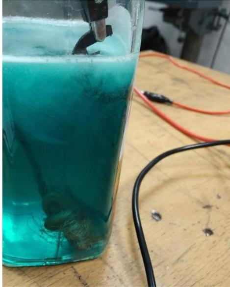
Fig. 330. Reacción de metalización en el electrolito desarrollado
