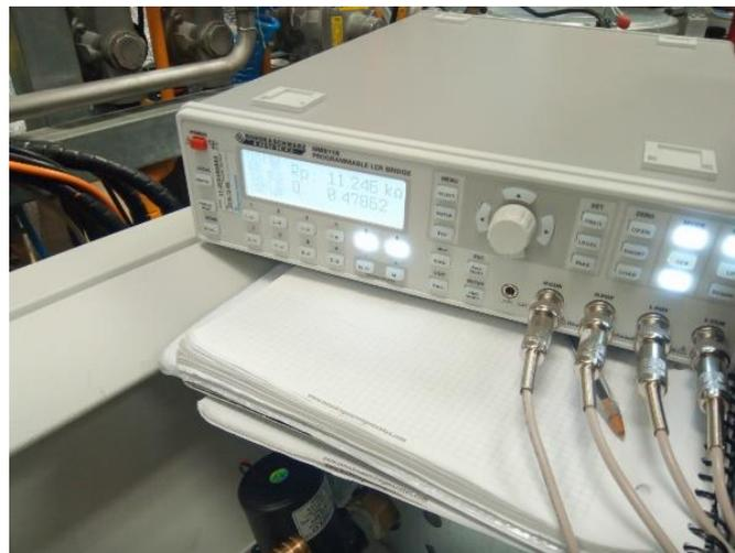
Fig. 111. Equipo de instrumentación electrónica RLC Bridge
