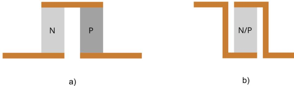
Fig. 276. Estructuras TE más habituales empleadas en la construcción de módulos TE a) con semiconductores N y P, y b) Usando solo un tipo.
