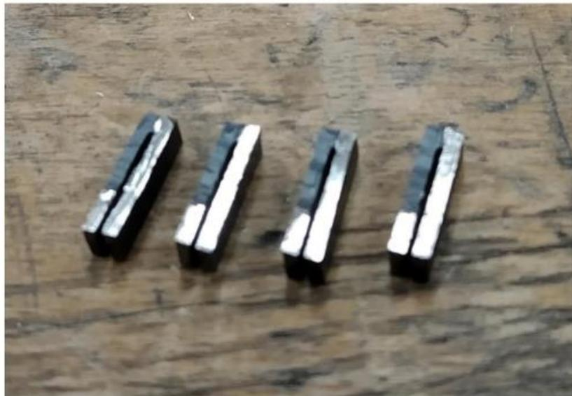
5- Patas metalizadas resultantes de material termoeléctrico
