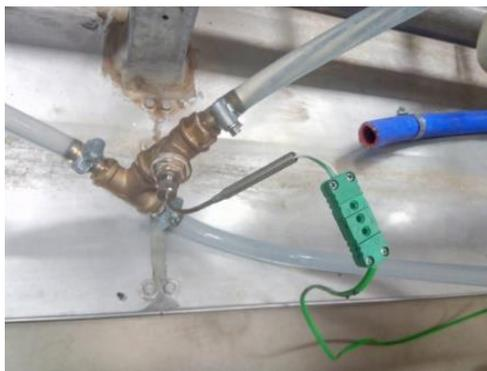
Fig. 109. Termopar tipo K, colocado en la salida del circuito de agua fría
