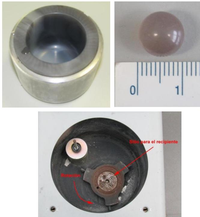
Fig. 289. Elementos del molino de bolas de ágata
