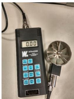
Fig. 225. Anemómetro empleado para la toma de medidas.
