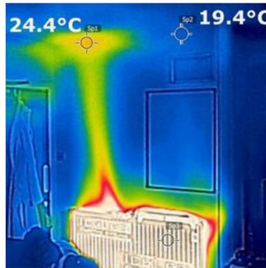
Fig. 36. Imagen térmica radiador con y sin dispositivo Radfan
