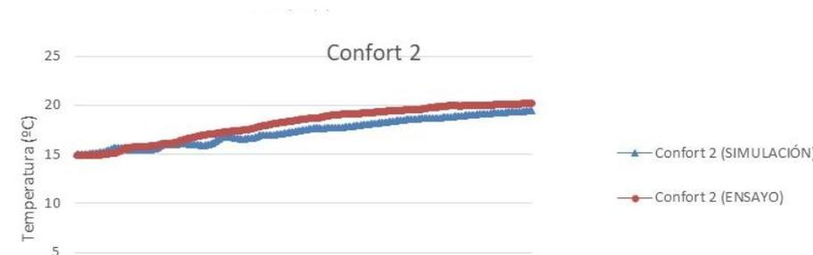
Fig. 254. Evolución de temperaturas para el punto *Confort 2*
