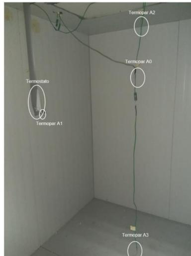
Fig. 252. Distribución de los termopares colocados en el interior de la cámara.
