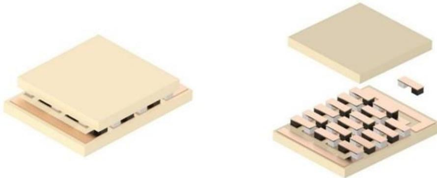
Fig. 42. Módulo termoeléctrico completo
