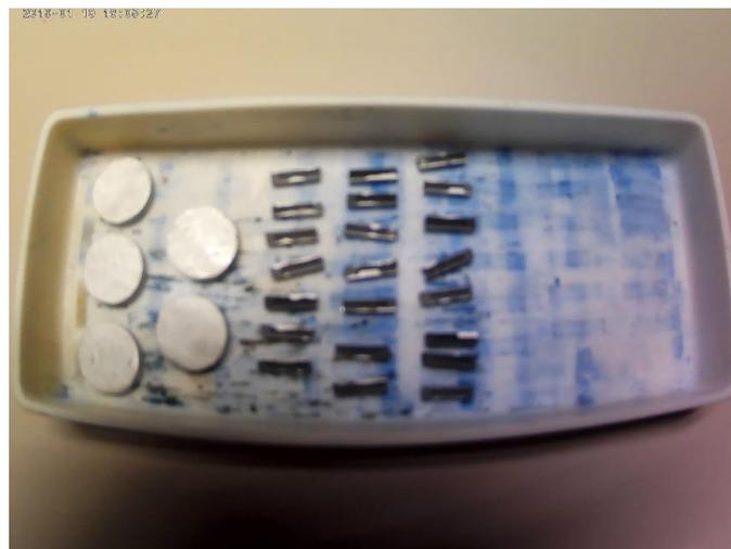
Fig. 325. Disco y piezas en  $\square$  metalizadas con plata tras el tratamiento térmico.
