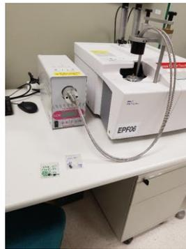
Fig. 297. DSC utilizado, junto a las muestras analizadas
