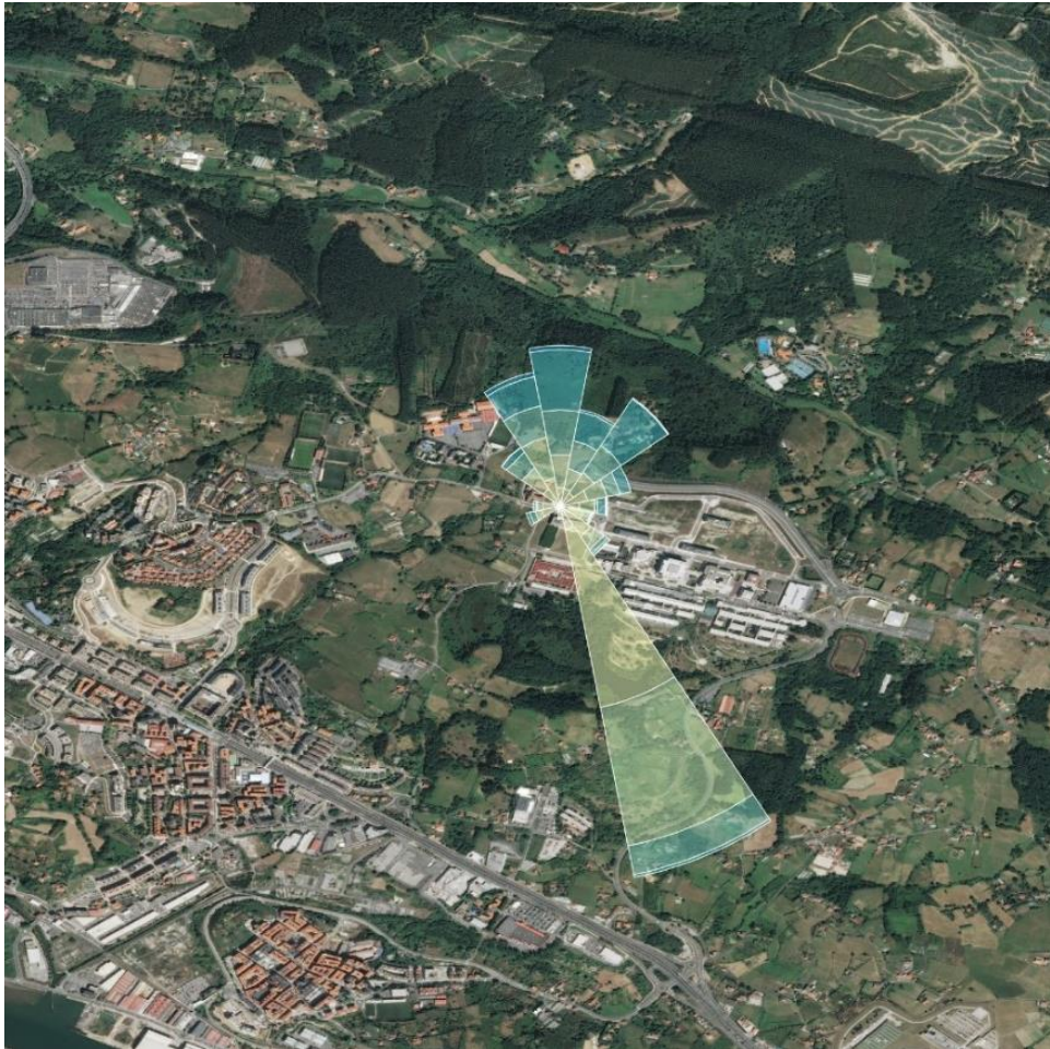
Imagen 5-6. Rosa de los vientos obtenida mediante los datos medidos por los anemómetros [17]
