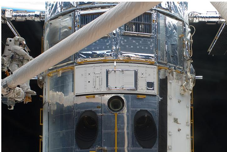
Figura 2.8: Astronautas trabajando en la instalación de la WFC3 en 2009. El panel blanco es la WFC3. Fuente: NASA.
