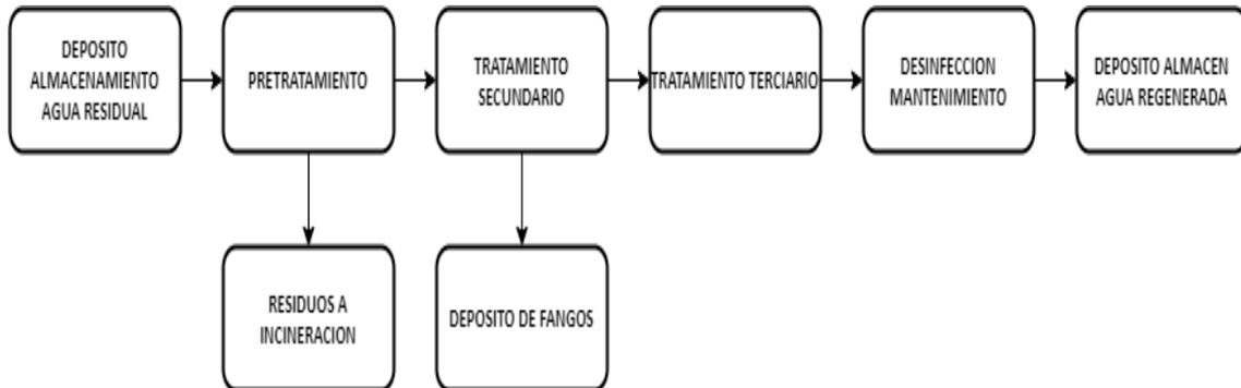
**Figura 12:** Esquema básico propuesto para la depuradora del agua residual
