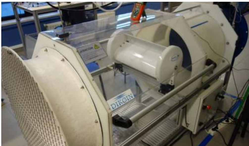
Irudia 4-14. Aerosorgailua haize tunelaren barruan sartzeko muntaia.
