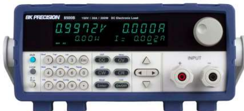
Irudia 6-13: Eibarreko laborategiko erresistentzia aldakorra
