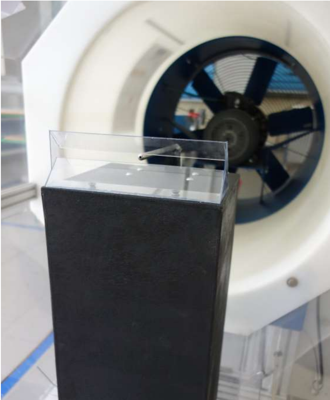
Irudia 6-5: Kontzentradorearen irteerako haizea neurtzeko Pitot hodiaren kokapena
