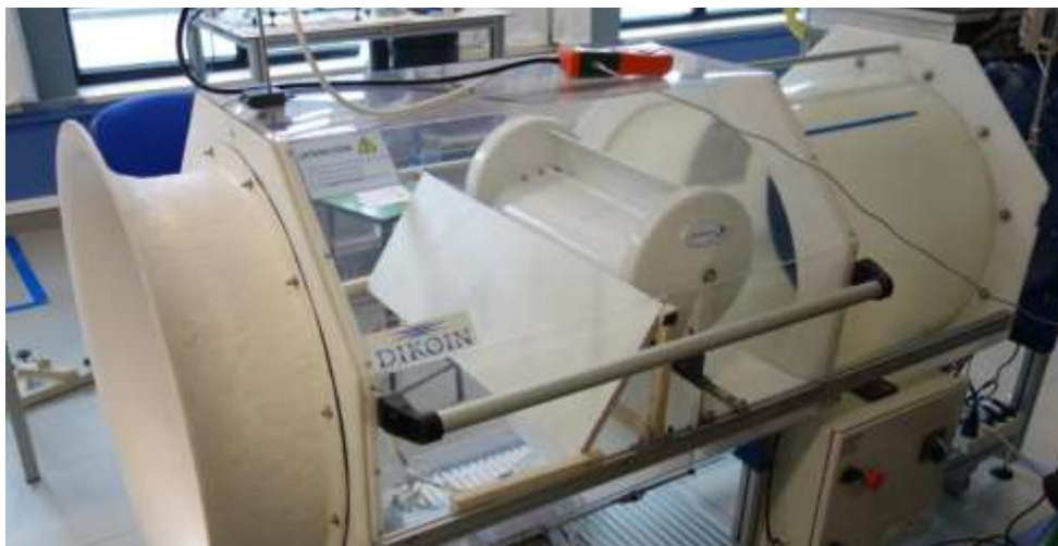
Irudia 4-16. Haize tunelaren barruan gauzatutako kontzentradorea simulatzen zuen esperimentua.
