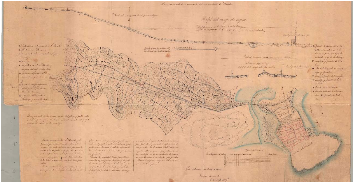
Ilustración 31_ Plano y perfil del viaje de agua que se proyecta establecer para conducir y distribuir dentro de la ciudad de San Sebastián (AM)
