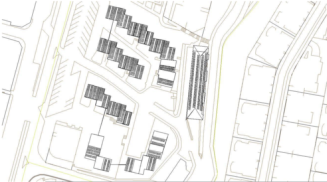
37. Imagen: Plano de la instalación fotovoltaica en las cubiertas del barrio hecho en Autocad. Fuente: Elaboración propia.
