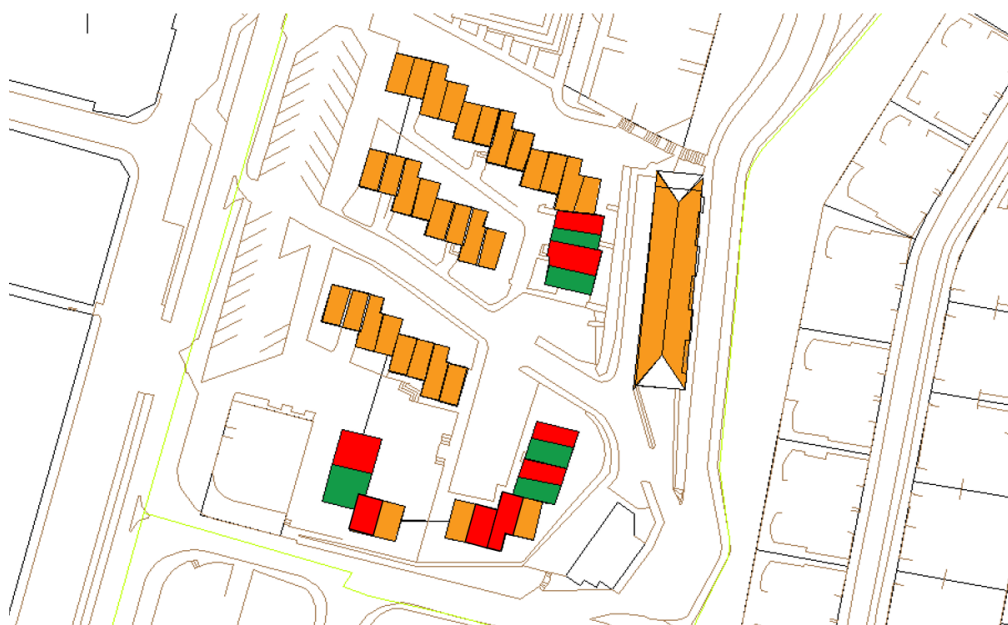
31. Imagen: Plano con la caracterización de las cubiertas del barrio en función de su generación eléctrica hecho en Autocad. Fuente: Elaboración propia.
