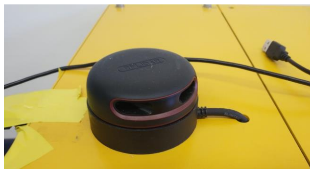
Figura 8: Sensor LiDAR del prototipo de AGV del departamento de sistemas de la EIV
