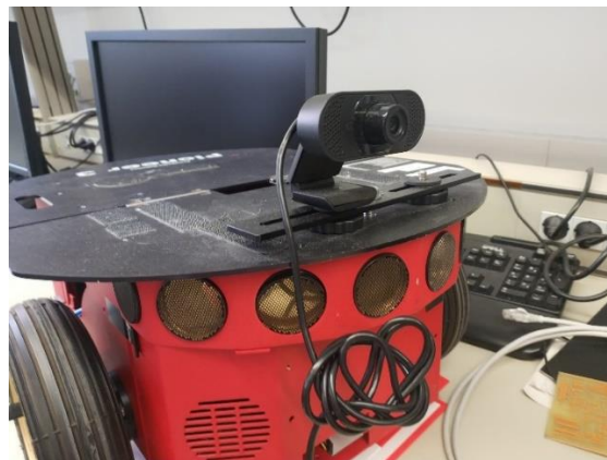
Figura 33: Webcam acoplada sobre el AGV
