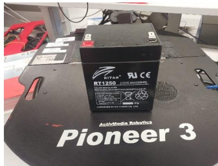
Figura 53: Baterías de 12V que alimentan al AGV
