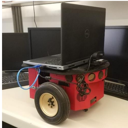
Figura 41: Estructura final del prototipo de AGV
