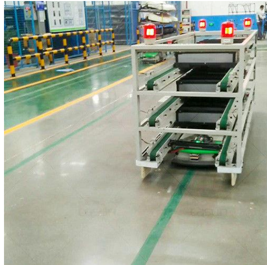
Figura 5: AGV comercial guiado por cinta magnética
