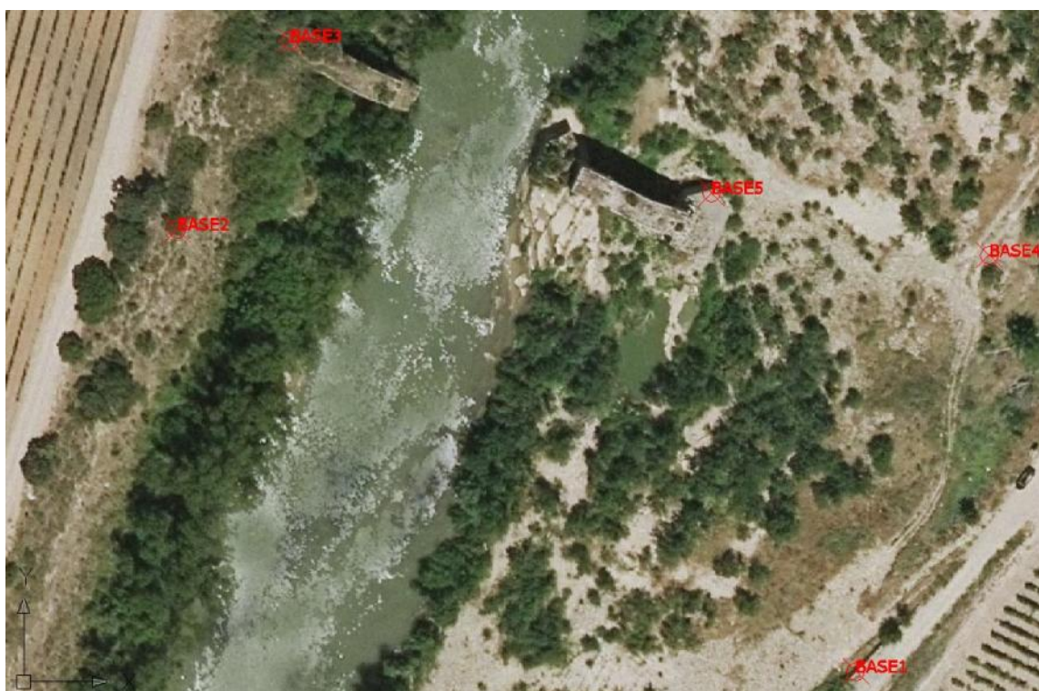
Fig. 8.- Distribución de las bases principales de la red topográfica establecida en 2017.
