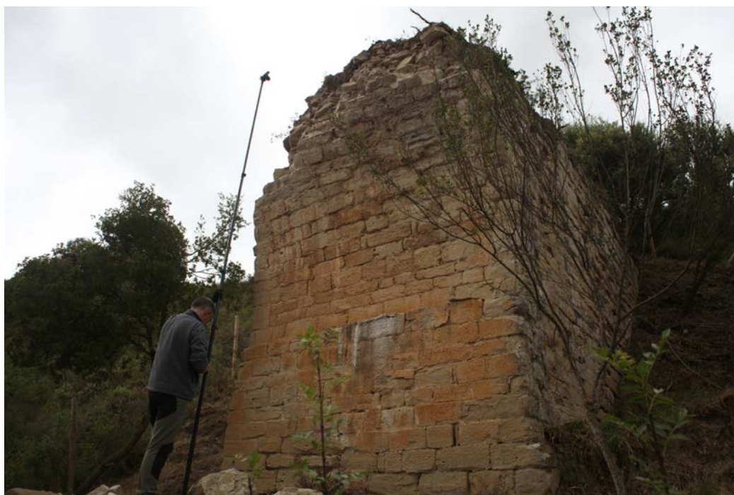
Fig. 11.- Registro fotográfico mediante cámara gobernada por wifi y jalón telescópico.
