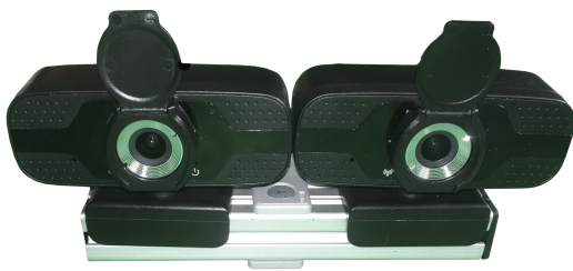
(a) Sistema de cámaras estereo Anvask Full HD 1080p 30 fps.
