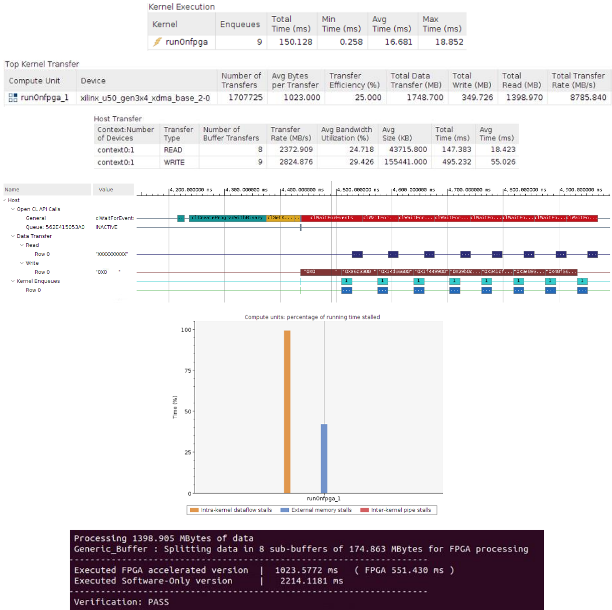
Figura 32: Resultados de ejecución en Alveo U50 del proyecto "Bloom Filter", mediante procesamiento de 8 muestras en paralelo, con una transferencia del buffer global dividida en 8 iteraciones, sin solapamientos
