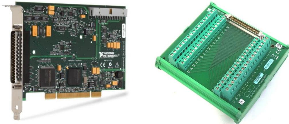
*Ilustración 22 - Tarjeta de adquisición NI PCI-6221 (izq.) y bornero TBX-68 (der.)*
