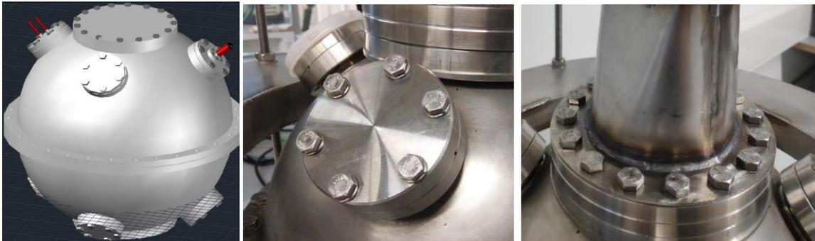
*Ilustración 18 - Diseño CAD del reactor (izq.), puerto de entrada CF40 (centr.) y puerto de entrada CF100 (der.)*[14]
