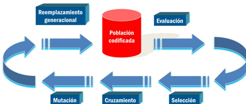
Ilustración 14 - Ciclo de ejecución de un algoritmo genético
