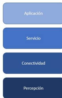
Ilustración 1 - Arquitectura de alto nivel IoT de cuatro niveles.
