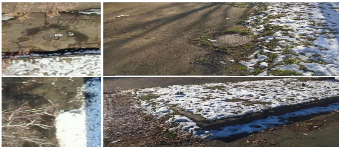
Figura 196. Aspecto de los objetos elegidos como puntos de GCP (puntos de control del terreno): a - marcado de la escotilla de la alcantarilla y su aspecto en el suelo; b - marcado de la frontera y su aspecto en el suelo
