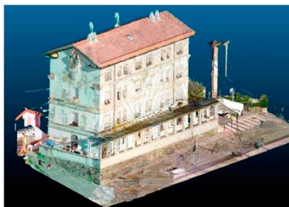
Figura 91 Modelo 3D final, combinando ambas nubes (Fuente: Urquiza & NorthBIM).
