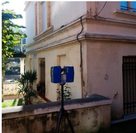
Figura 88. Escáner FARO Focus 3D x 330 sobre trípode (Fuente: Urquizo Ingenieros e NorthBIM)
