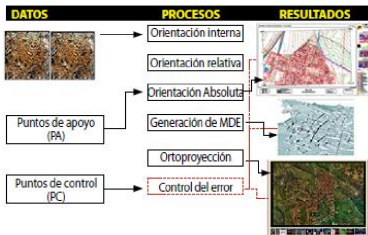
Figura 23. Fases del proceso de control digital
