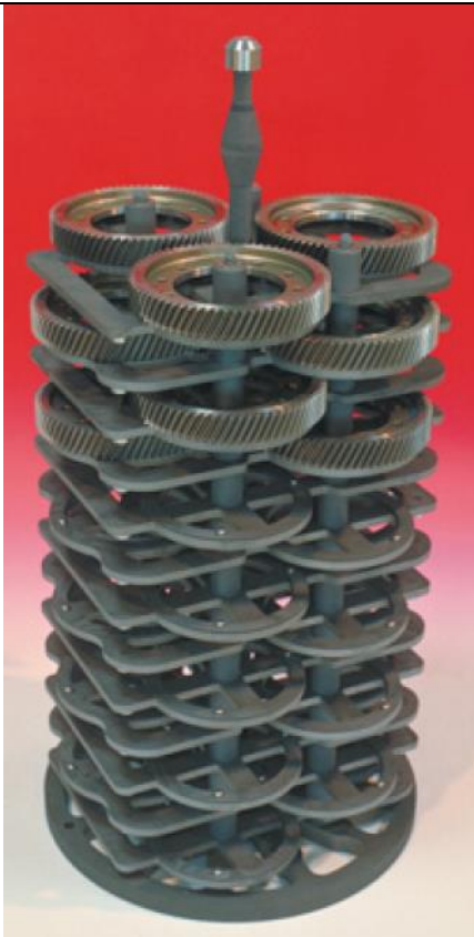
Figura 17. Suelas de soporte de piezas para tratamiento térmico.
