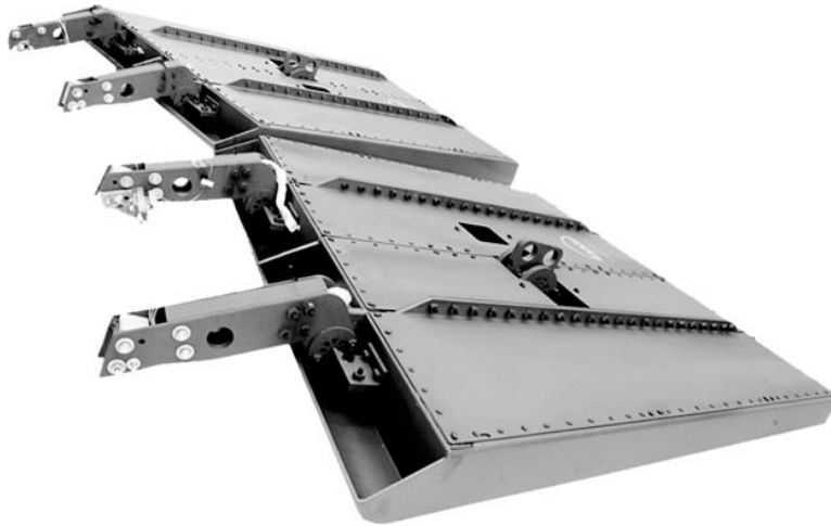
Figura 20. Aletas de cuerpo CVI-Cf/SiC para X-38, unidas con tornillos C / SiC. El Body Flap fue desarrollado por MAN-T en el marco del programa alemán TETRA que se llevó a cabo por orden de DLR y patrocinado por la BMBF y el STMWVT de Baviera.
