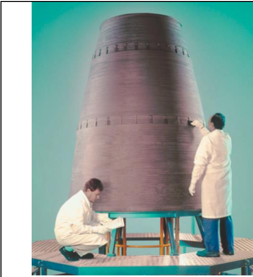
Figura 12. Parte divergente desplegable del motor del segundo piso del cohete americano Delta 4.
