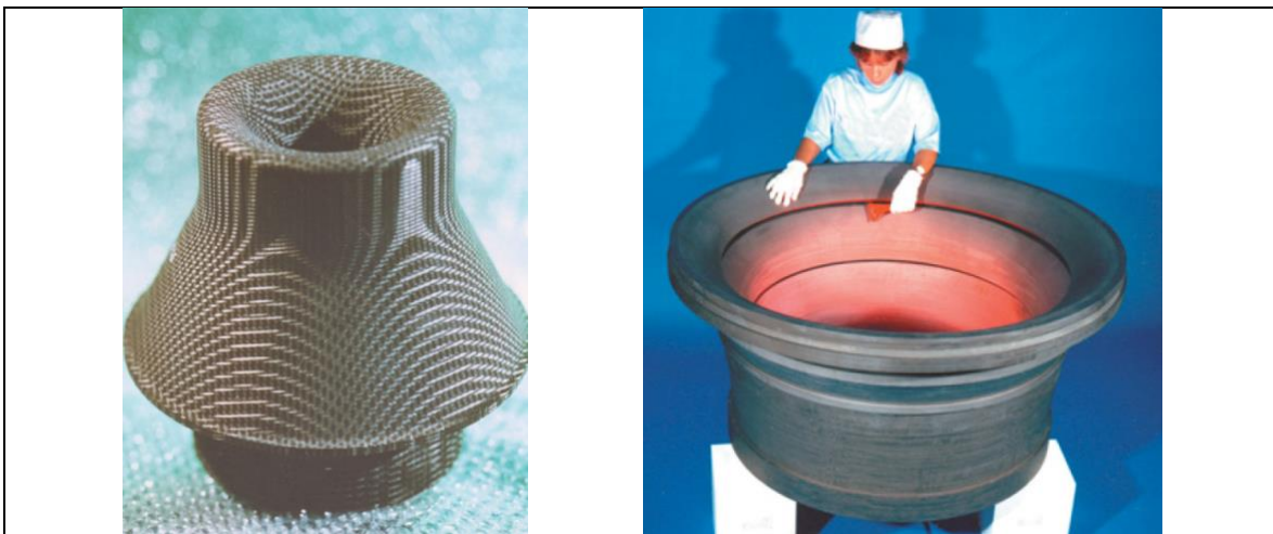
Figura 4. Cuello de boquilla 4D para aplicaciones de defensa: (izda.) Arquitectura fibrosa; (dcha.) Cuello de boquilla finalizado de los boosters del cohete Ariane V.
