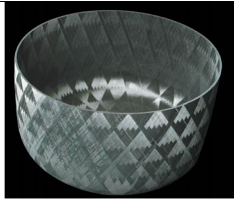
Figura 16. Crisol para la fabricación de monocristales de SiC (diámetro 800 mm).
