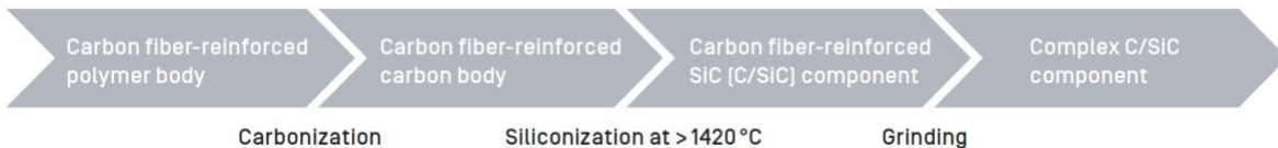
Figura 58. Propiedades globales del SIGRASIC® y proceso de fabricación.
