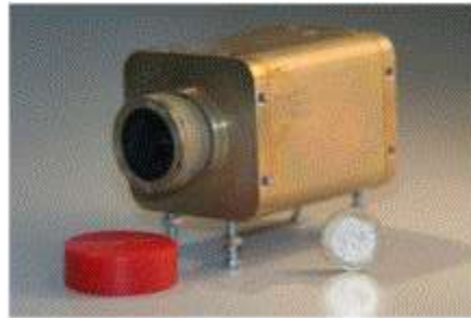
Figura 7. Imagen de la cámara VMC (Ormston et al., 2011)
