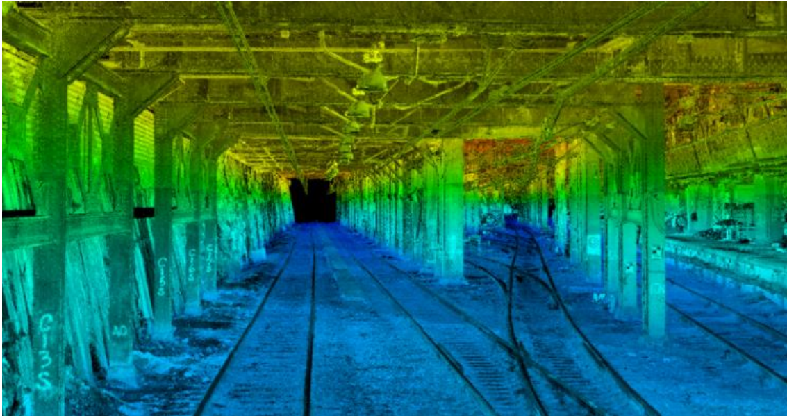
Ilustración 6: Estudio de la estación Penn de Nueva York mediante LiDAR [21].
