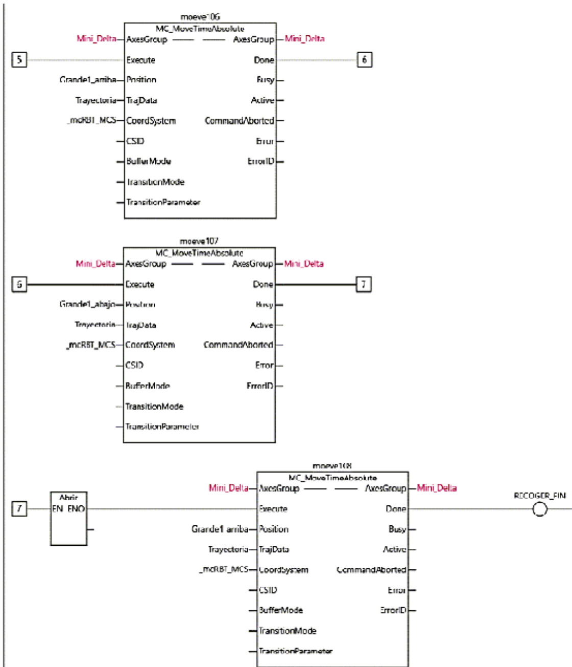
43 Cogida y recogida completada, nos movemos a la derecha y a los 5 segundos se completa el proceso.
