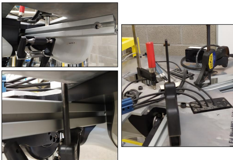
Figura V.25. Colocación de los perfiles y los sargentos.
