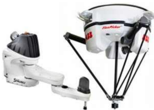
Figura 1.3. Robot tipo SCARA (izquierda) y Robot tipo DELTA (derecha).
