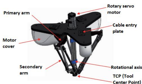
Figura 4.5. Partes del robot Delta CR-UGD4MINI-NR.
