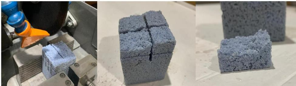
Figura 42: Obtención de muestras de las probetas de 5MVA.
