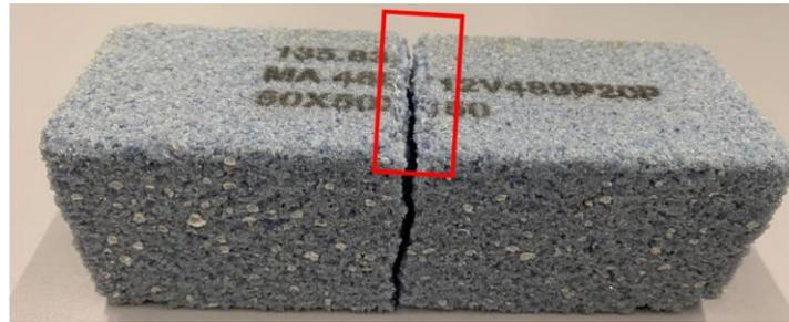
Figura 32: Marcas de indentación de los rodillos del bloque 1 de ensayos
