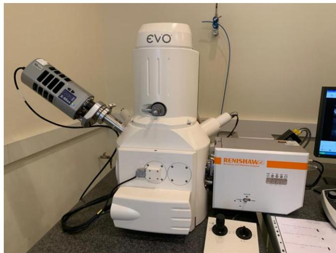
Figura 40: Equipo de Microscopía de Barrido Electrónico Carl Zeiss EVO-40.
