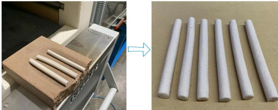
Figura 37: Probetas de aglomerante vítreo tras el ciclo de sinterizado.
