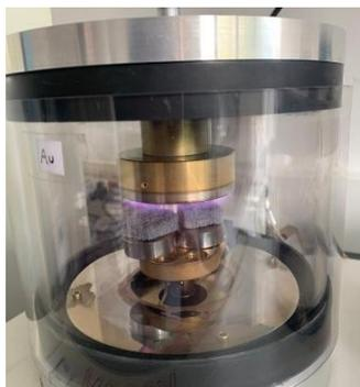
Figura 43: Recubrimiento de oro sobre las muestras de alúmina monocristal.
