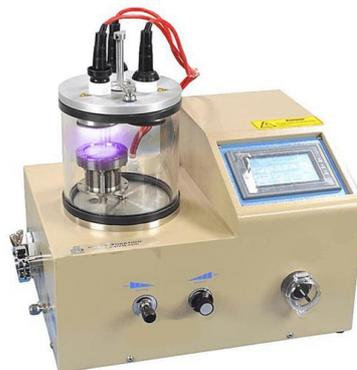
Figura 41: Equipo metalizador por sputtering.
