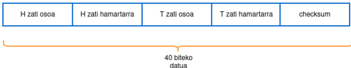
4.3. Irudia: DHT-11 sentsoreak bidalitako datu baten formatua
