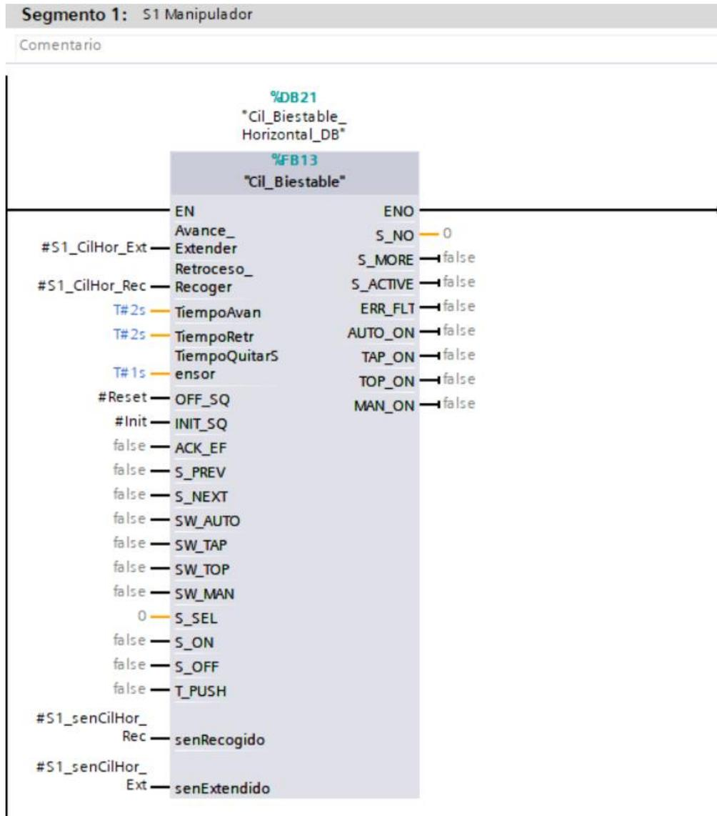
Figura 5.43: GFB - Instancias – S1 - Cilindro Horizontal
