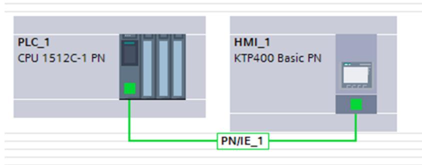
Figura 5.27: Conexión PLC y HMI mediante PROFINET
