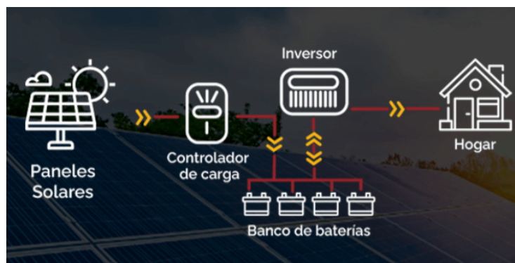
Fig. 3-5. Esquema general de un sistema solar fotovoltaico aislado.
