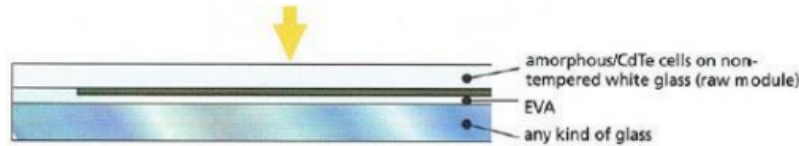
Fig. 3-14. Módulo de silicio amorfo o CdTe.
