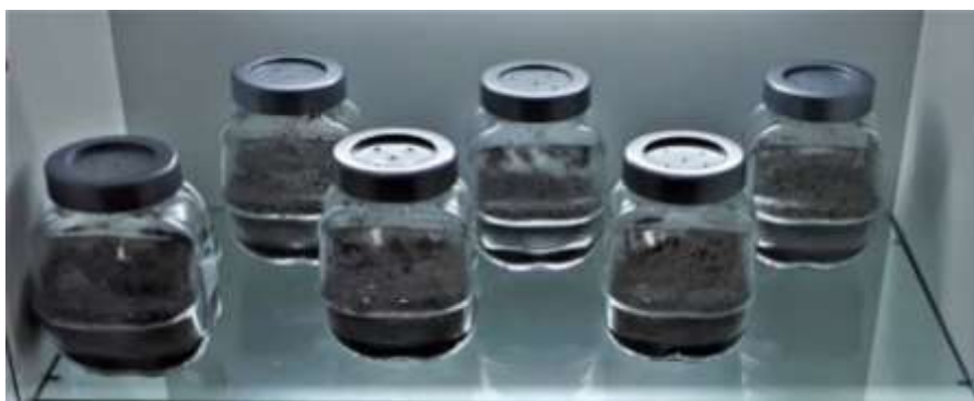
1. irudia. 0mg/kg, 10 mg/kg, 100 mg/kg eta 1000 mg/kg tetraziklina-kontzentrazioak dituzten OECD lur artifizialez betetako beirazko ontziak.
