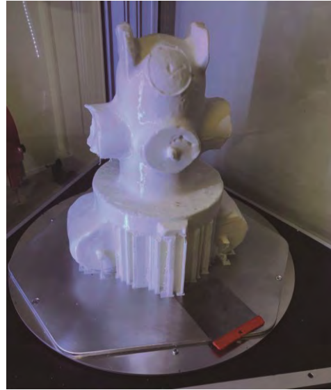
Figuras 720 y 721. Fotografías de las fases constructivas de la pieza Izar con la impresora 3D.
