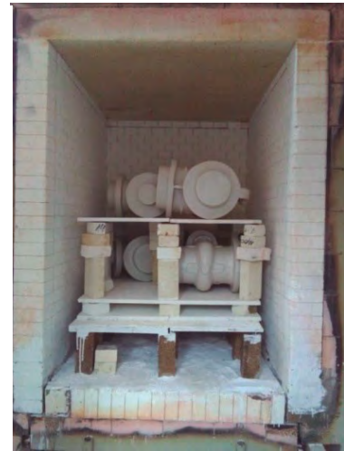
Figuras 714, 715, 716 y 717. Fotografías de las diferentes fases en la producción de las piezas cerámicas: (1) encofrado del modelo industrial para verter la escayola; (2) molde de escayola; (3) pieza cerámica hecha por el método del apretón y cosido de las dos partes simétricas; y (4) horneado de la pieza cerámica. Dentro de la variedad de materialidades y acabados que proporciona la cerámica, se emplean arcillas de baja temperatura, refractarios y greses, con acabados como vidriados, kintsugi 154 o " terra sigillata " 155 .
