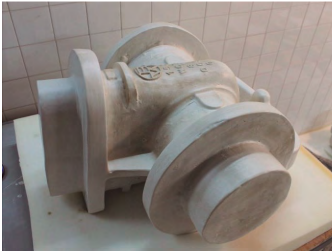
Figuras 714, 715, 716 y 717. Fotografías de las diferentes fases en la producción de las piezas cerámicas: (1) encofrado del modelo industrial para verter la escayola; (2) molde de escayola; (3) pieza cerámica hecha por el método del apretón y cosido de las dos partes simétricas; y (4) horneado de la pieza cerámica. Dentro de la variedad de materialidades y acabados que proporciona la cerámica, se emplean arcillas de baja temperatura, refractarios y greses, con acabados como vidriados, kintsugi 154 o " terra sigillata " 155 .
