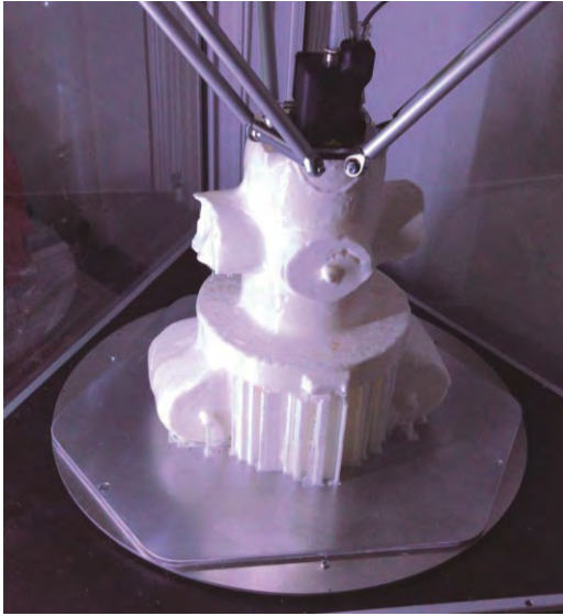
Figuras 720 y 721. Fotografías de las fases constructivas de la pieza Izar con la impresora 3D.
