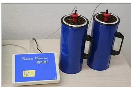
Figura 26. Equipo básico del test de autocalentamiento (Amare natura. 2015).
