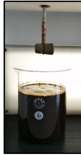
Figura 50. Muestra madura-húmeda dentro del Jar test.
