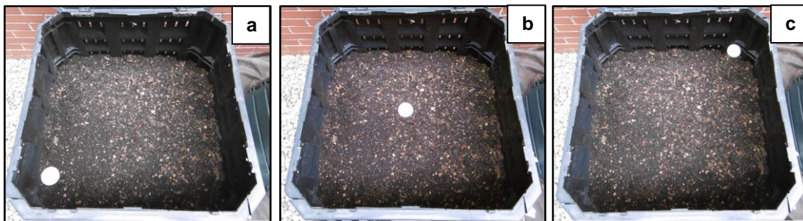
Figura 35. Procedimiento de medición de la T en la zona delantera (a), central (b) y trasera (c).
