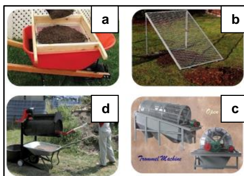
Figura 24. Formas de realizar el cribado: horizontal (a), oblicua (b), industrial (c) y motora (d).
