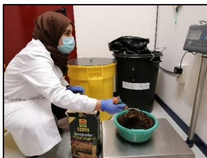
Figura 28. Báscula industrial empleada para la pesada de los RO.
