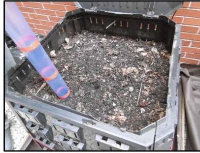
Figura 34. Extracción de las muestras mediante un tubo perforado.
