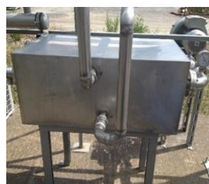
Figura 4.9a. Intercambiador de calor.
