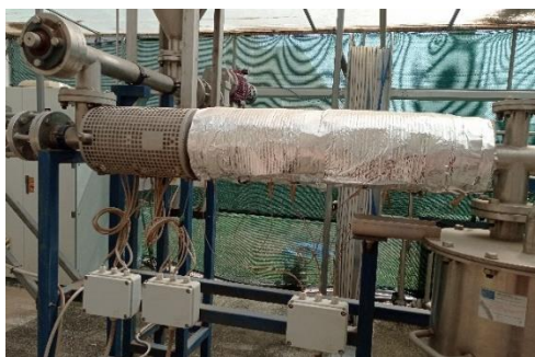
Figura 4.6. Sección precalentada del reactor de pirólisis.
