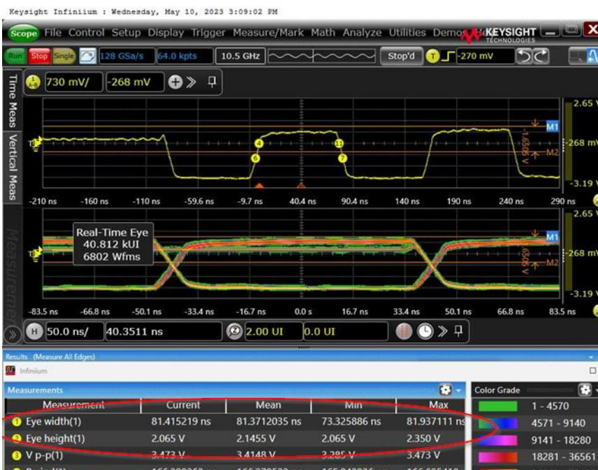
Ilustración 164: Altura y anchura del ojo
