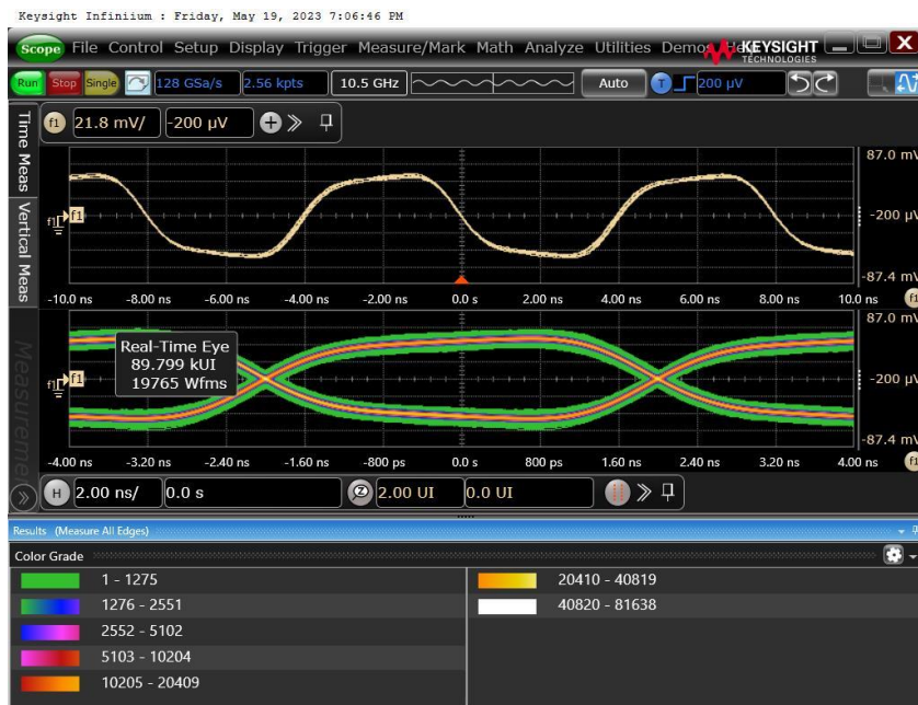
Ilustración 157: Diagrama de ojo en modo de test 2
