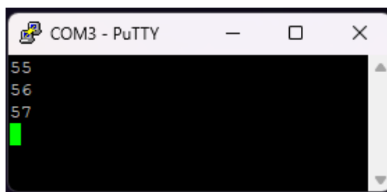
Figura 17: Valores recibidos por I2C impresos por UART
