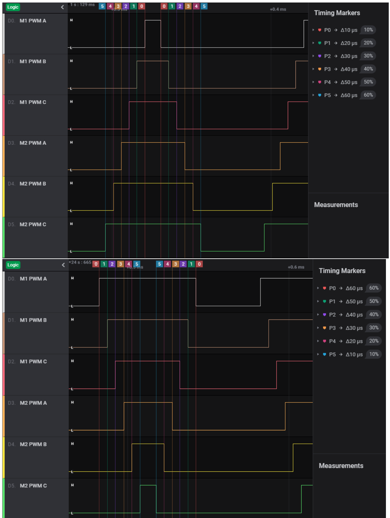
Figura 15: Verificación de las salidas PWM
