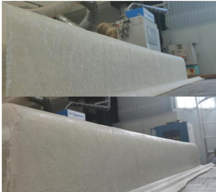
Figura 40. Arriba la versión 1 del contramolde fabricado sobre prepregs sin curar y abajo la segunda versión del contramolde fabricado sobre superficie lisa.
