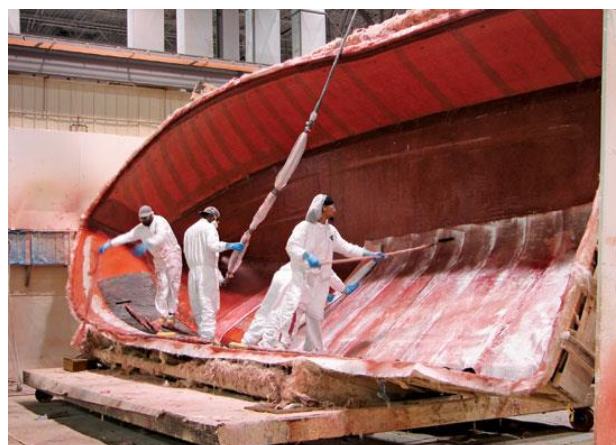
Figura 10. Imagen representativa del proceso de Hand lay-up en la que se puede ver a varios operarios impregnando tela de fibra de vidrio con rodillo.
