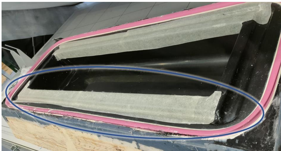
Figura 41. Diseño de los anclajes de los prepregs y evitar así su desplazamiento. Fabricados con las mismas características que el contramolde de la pieza completa.
