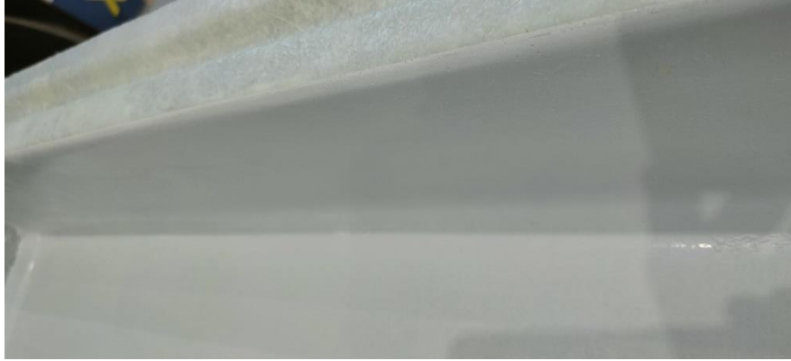
Figura 39. Base lisa a partir de una pieza para la fabricación del contramolde.
