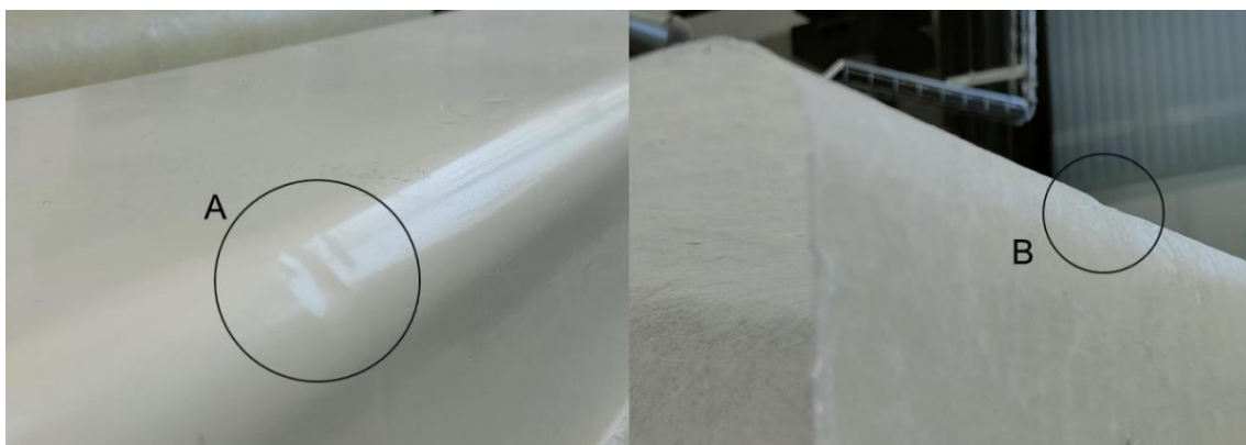
Figura 38. El defecto A de la pieza final está formado por la imperfección B del contramolde utilizado para fabricarla.
