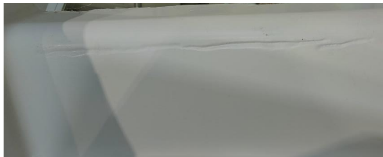
Figura 37. Defecto de pliegues formados en los preimpregnados.
