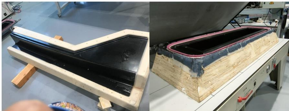
Figura 36. Moldes con la primera versión de la adaptación al proceso de UVDF.
