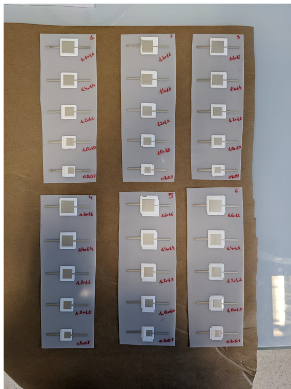
27 Irudia: Dimentsio ezberdineko kondentsadoreen 6 lagin. Goitik behera mm 2 -tan: 16x16, 12x12, 14x14, 12x12, 10x10 eta 8x8. 1, 2 eta 4 laginak dielektrikoaren 3 kapa eta 3, 5 eta 6 laginak 4 kapa.
