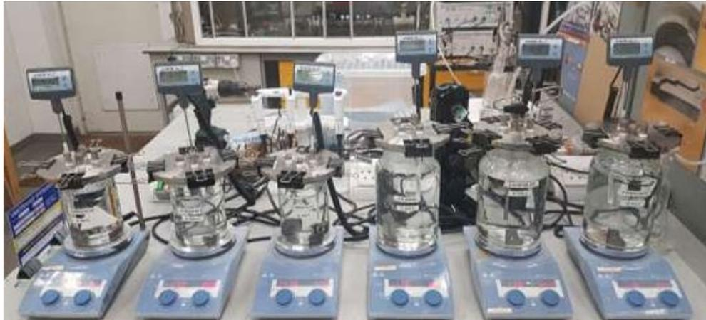
**Imagen 1.** Probetas sometidas a los entornos de corrosión
