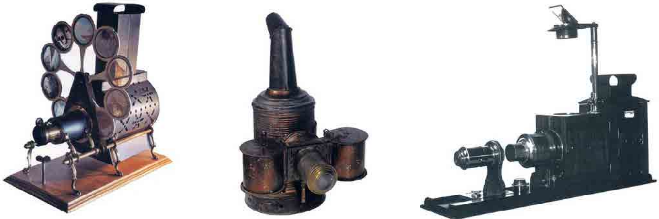
FIGURA 57 - Diferentes modelos de Linterna Mágica: 1/ Linterna Mágica "The Pettibone", Cincinnati, 1893, 2/ Linterna mágica provista de doble cargador a tambor completo de manivelas para la proyección continua de imágenes sobre papel de pergamino. Sistema de iluminación a petróleo, 25 x 30 x 35 cm, Berlín, 1879, 3/ Linterna Mágica, Bradford, 1890, en ZOTTI MINICI, C. Alberto, Magiche visioni prima del cinema. La collezione Minici Zotti , Padova, Il Poligrafo, 2001, pp. 59, 100 y 77.
