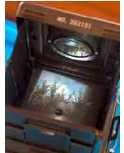
FIGURA 58 - Formación de la imagen por el mecanismo de cámara óptica, en una cámara fotográfica Seagull.
