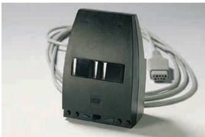
Figura 28: Transmisor IR por puerto serie
