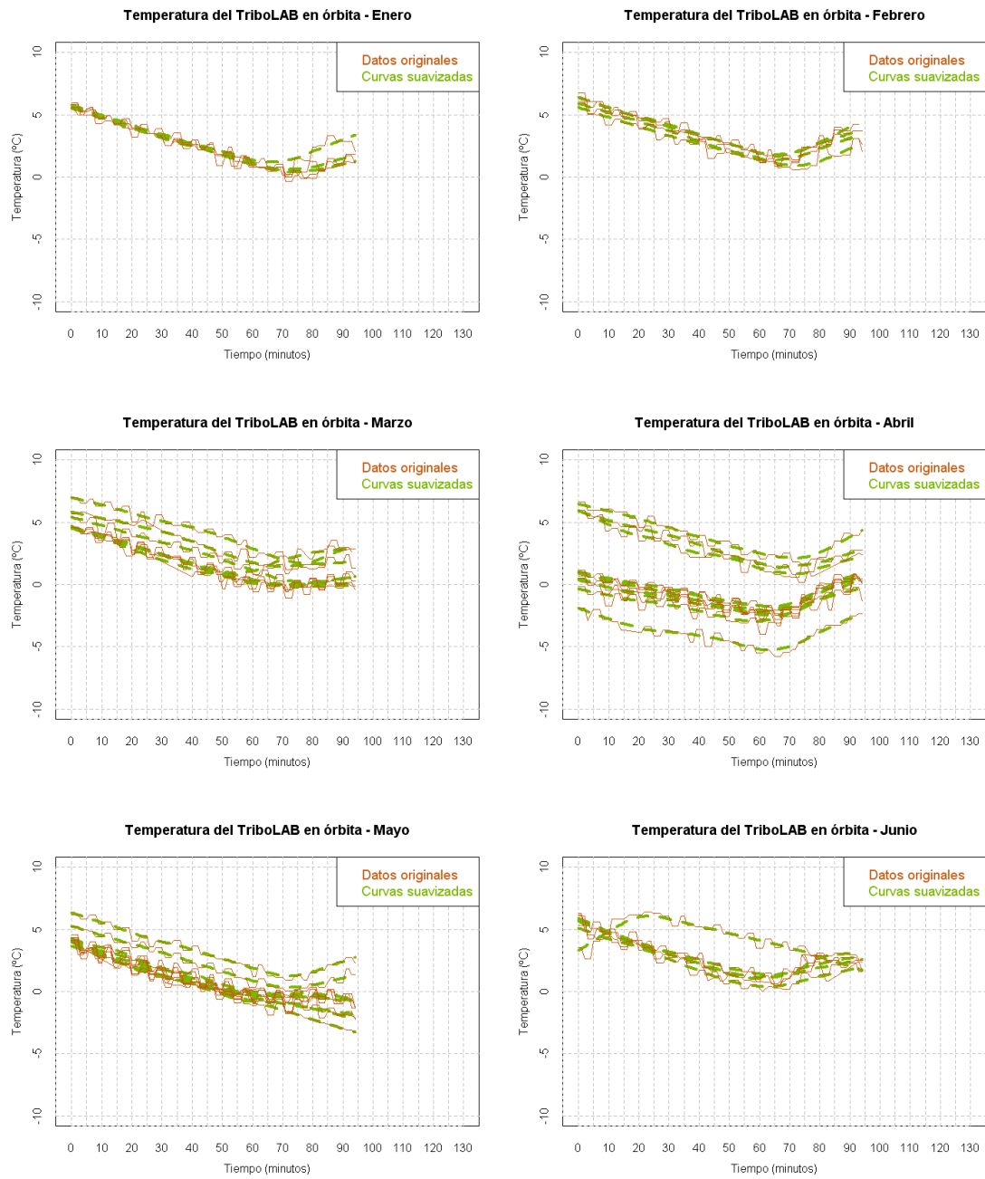
Fig. 67. Temperatura del TriboLAB en órbita junto con sus curvas suavizadas correspondiente a los periodos seleccionados pertenecientes a los seis primeros meses del año.
