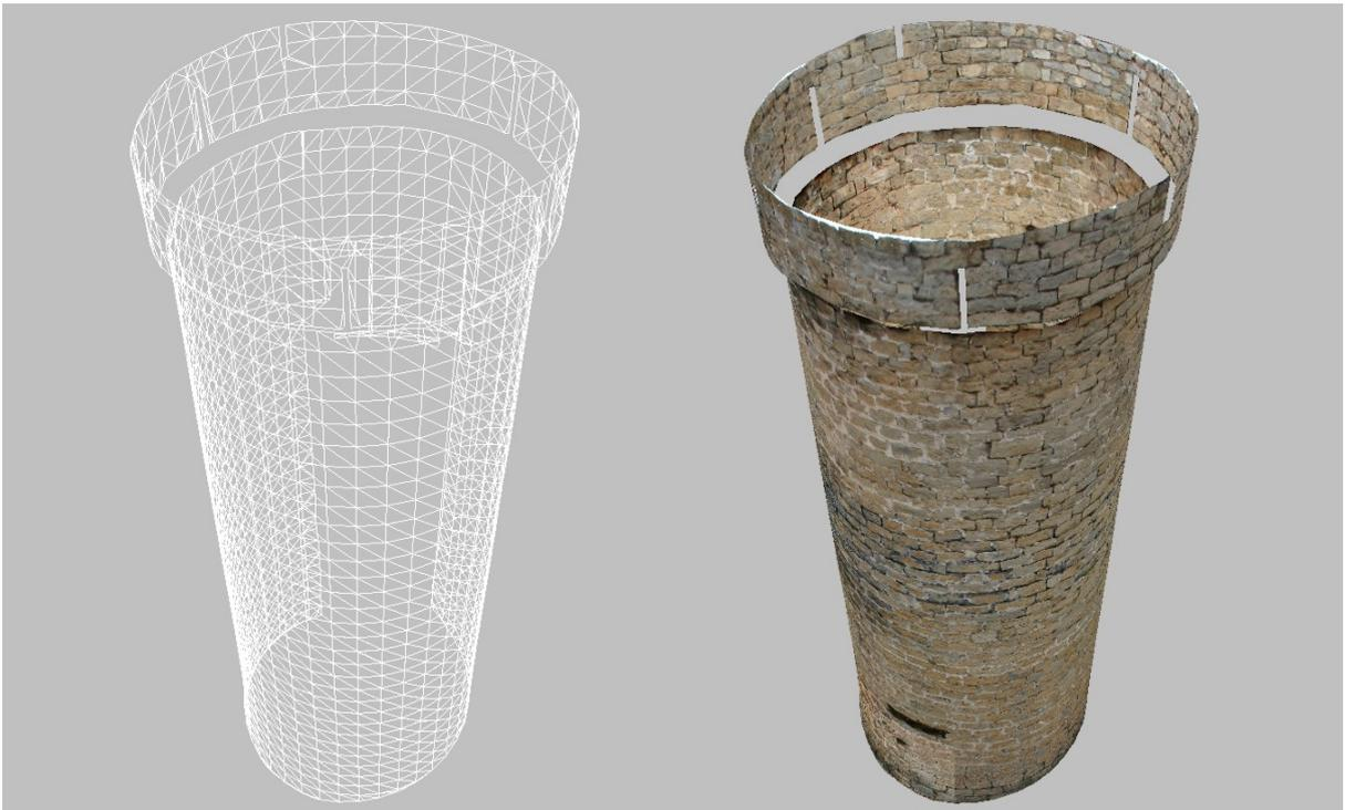
Para completar cada una de las torres es necesario utilizar varias fotografías (entre 6 y 20 según la complejidad), para las paredes rectas suelen ser suficiente con una o dos fotografías. En cualquier caso, a pesar del cuidado en la toma de las imágenes, cada fotografía tiene diferente iluminación por lo que el resultado visual es un conjunto de parches.
