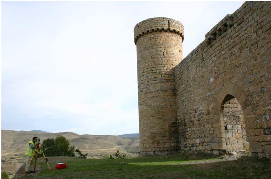
Además de estos puntos, se procedió a medir una serie de señales de puntería que se situaron sobre las paredes y que se utilizan durante el proceso de rectificación fotográfica. Estas señales de 4 x 4 cm de tamaño se sitúan mediante un jalón telescópico que permite colocarlas hasta 6 metros de altura.
