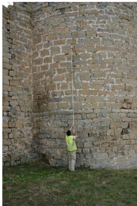
Las señales de puntería también se utilizaron para estacionar mediante intersección inversa en las estaciones adicionales que fueron necesarias, por ejemplo, en la parte alta de las torres para medir el paso de ronda.
